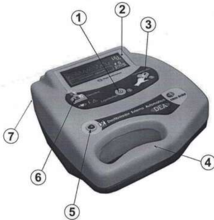
Figura 3: Identificação Geral do Desfibrilador Life 400 FUTURA – DEA
