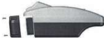
Figura 11: Colocação da bateria (visão lateral)
