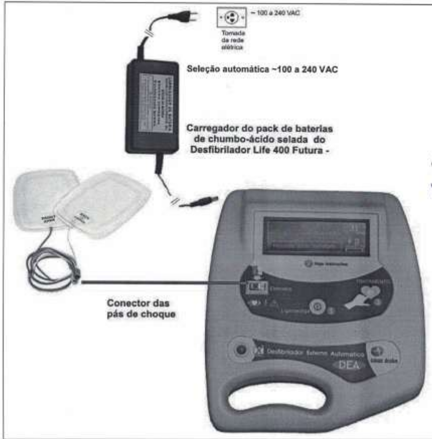
Figura 10: Conexão dos cabos e acessórios do Desfibrilador Life 400 FUTURA – DEA
