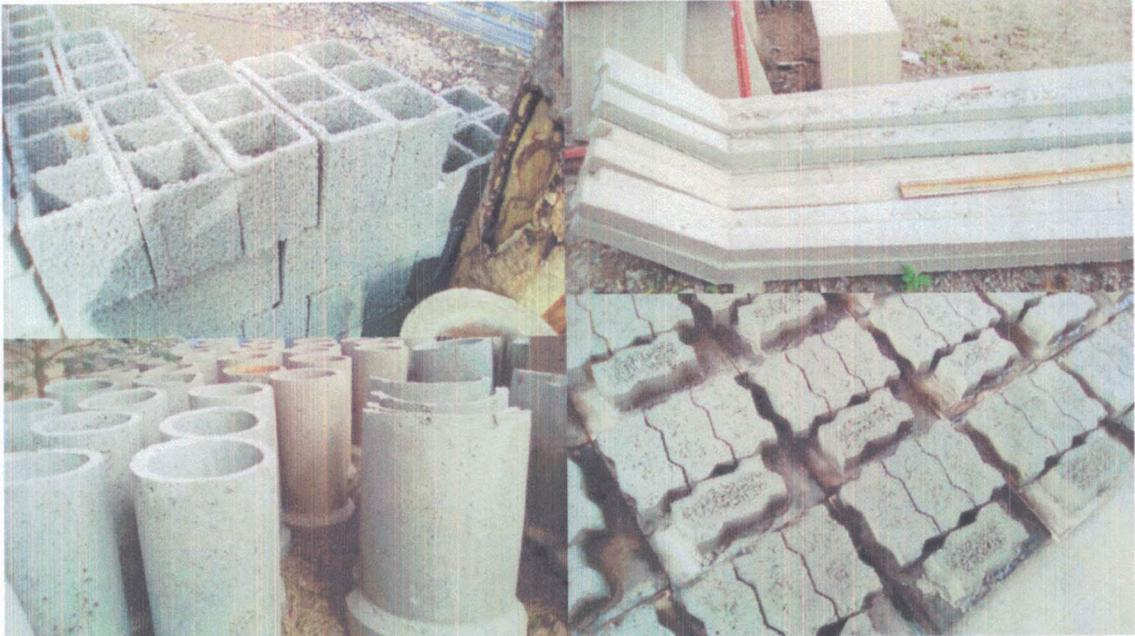
**Foto: Usina de Reciclagem de Entulho / material confeccionado com entulho reciclado**
